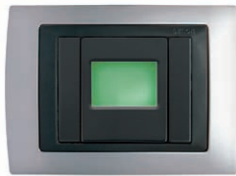
Pasen - Esperen Indica el estado de ocupación de la oficina, mediante una luz que cambia de color
